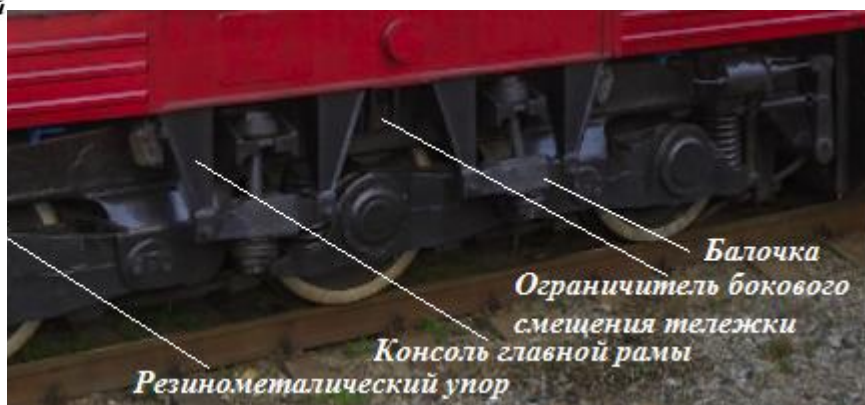
Рисунок 19 Боковая опора тепловоза ЧМЭЗ
