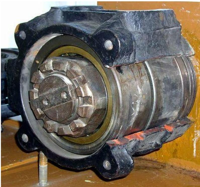
*БУ с роликовыми цилиндрическими подшипниками.*
