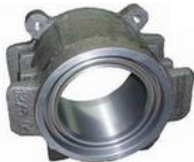
**Корпус буксы** – предназначен для размещения элементов БУ и смазки.
