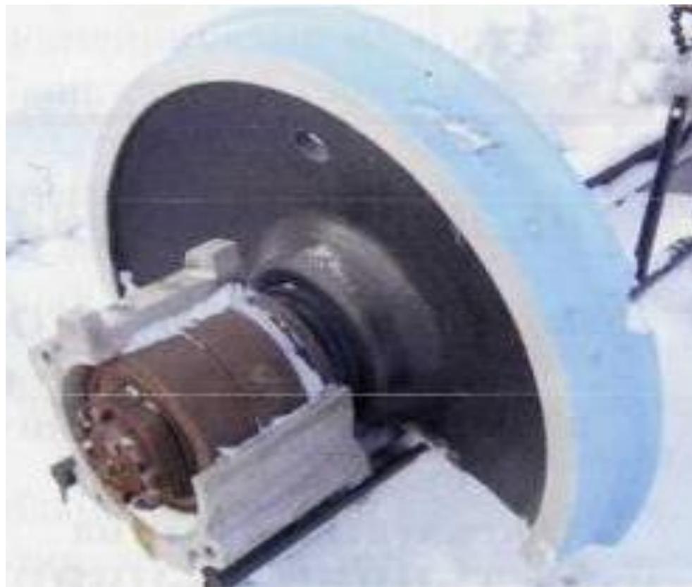
**Буксовый узел** служит для соединения КП с рамой тележки вагона, передачи нагрузок от кузова вагона на шейки осей КП, а также для ограничения поперечного и продольного перемещений КП относительно тележки при движении вагона
