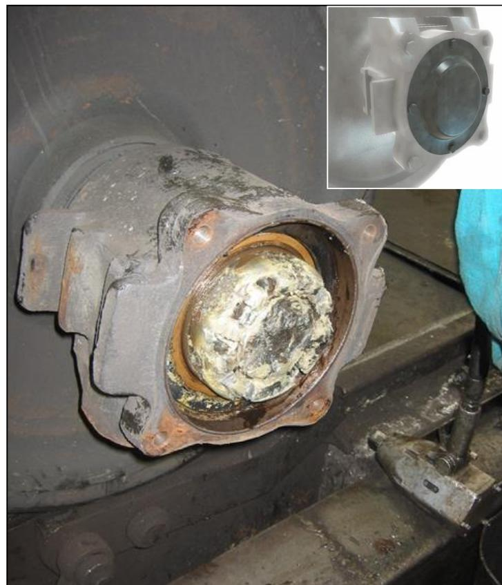
**Смотровая крышка** – предназначена для осмотра переднего подшипника и состояния смазки, а также обточки КП без демонтажа БУ.
