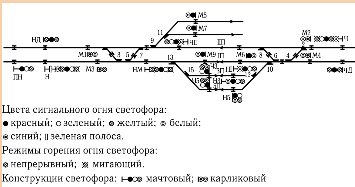
Рис. 2.1. Поездные и маневровые светофоры и их расположение на станции.
