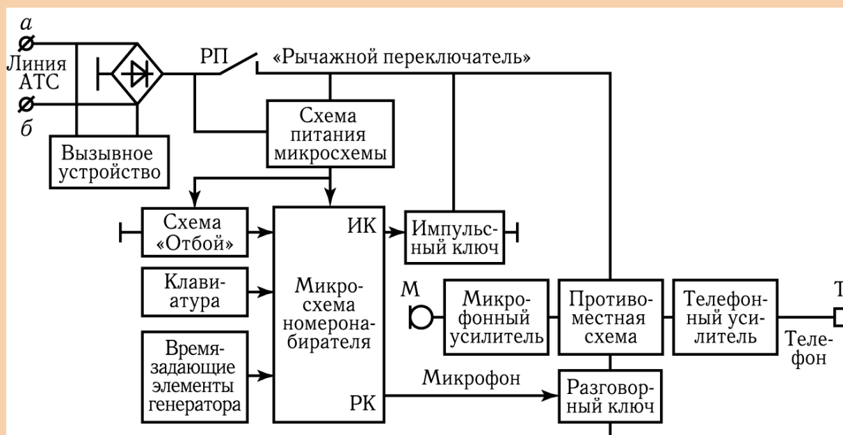
Рис. 16.8. Структурная схема ТА отечественного производства
