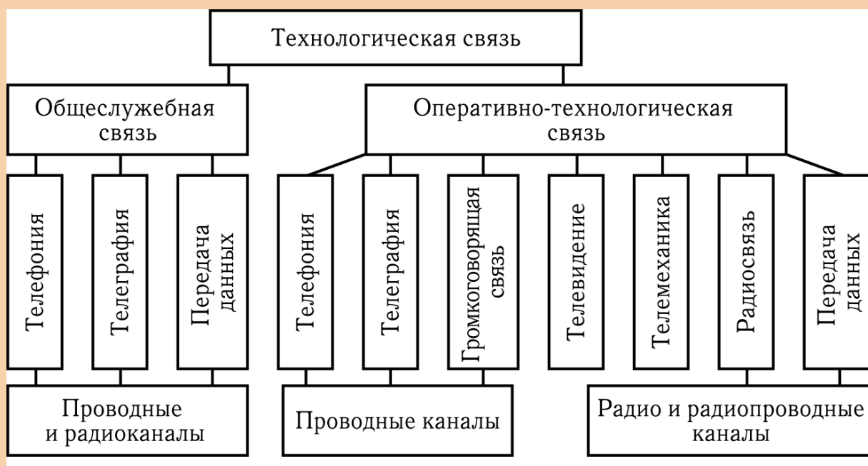
Рис. 20.1. Структурная схема классификации технологической связи
