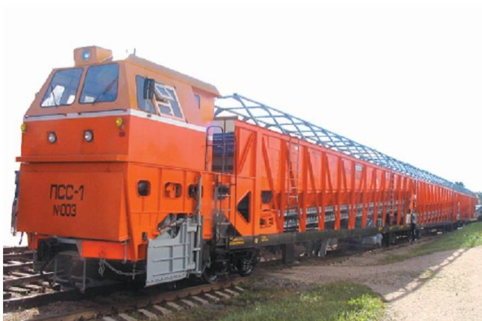
Рис. 13. Подвижной снегоочистительный состав ПСС-1.
