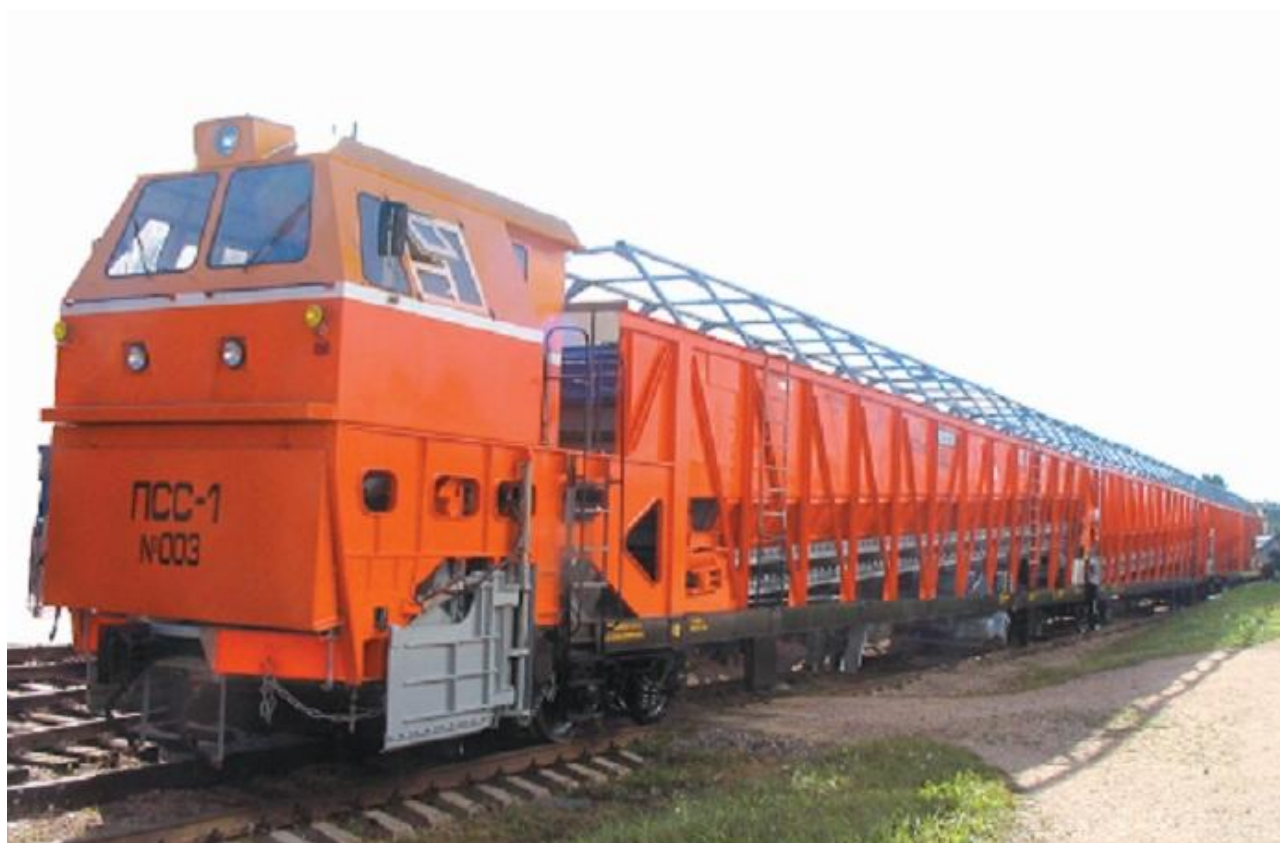
Рис. Подвижной снегоочистительный состав ПСС-1.
