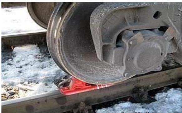
Рисунок 21. Закрепление тормозным башмаком
