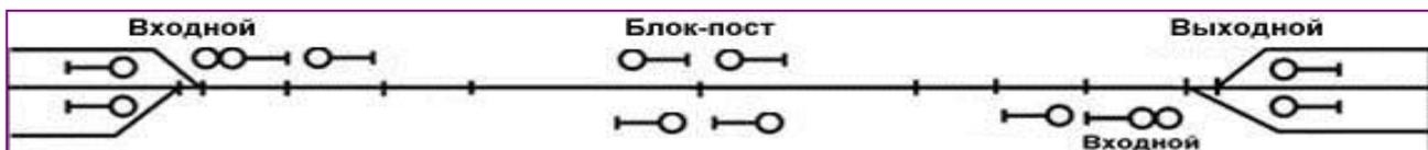
Рисунок 9. Схема перегона ПАБ, оборудованного блок-постом
