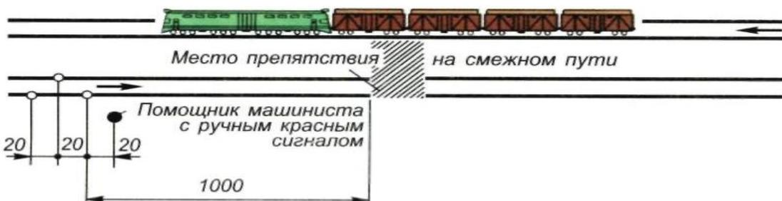
Рисунок 16. Схема ограждения грузового поезда при возникновении препятствия на смежном пути
