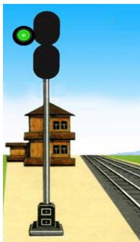
Рисунок 6. Выходной светофор, оборудованный повторительной головкой
