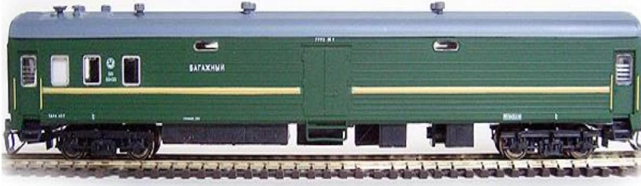
*Багажный вагон* – предназначен для перевозки багажа. Вагоны имеют кладовые с погрузочно-разгрузочными механизмами и помещения для обслуживающего персонала .
