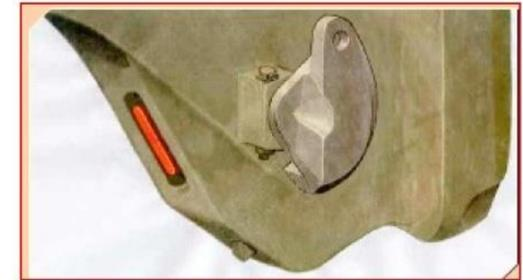
После установки замка вставляется валик подъемника через отверстие в голове корпуса (со стороны малого зуба) так, чтобы отверстие для цепи, имеющееся на его противовесе, находилось вверху. При этом стержень валика проходит через овальный вырез замка и своей квадратной частью входит в отверстие подъемника, а круглый конец стержня входит в отверстие корпуса со стороны большого зуба
