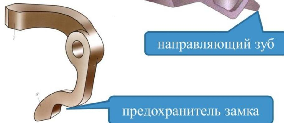
В верхней части замка имеется цилиндрический прилив (шип), на который навешивается предохранитель замка (собачка). В средней части замка предусмотрен овальный валик подъемника.
