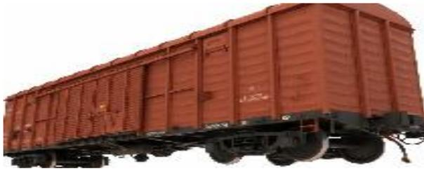
**Крытые** (4-х осные) – предназначены для перевозки грузов, требующих защиты от атмосферных воздействий и механических повреждений (сыпучие грузы, пищевые продукты, промышленные товары), а также для транспортировки тароупаковочных и высокоценных грузов. Вагон имеет закрытый кузов, оборудованный дверьми и люками для погрузки/выгрузки и очистки кузова).
