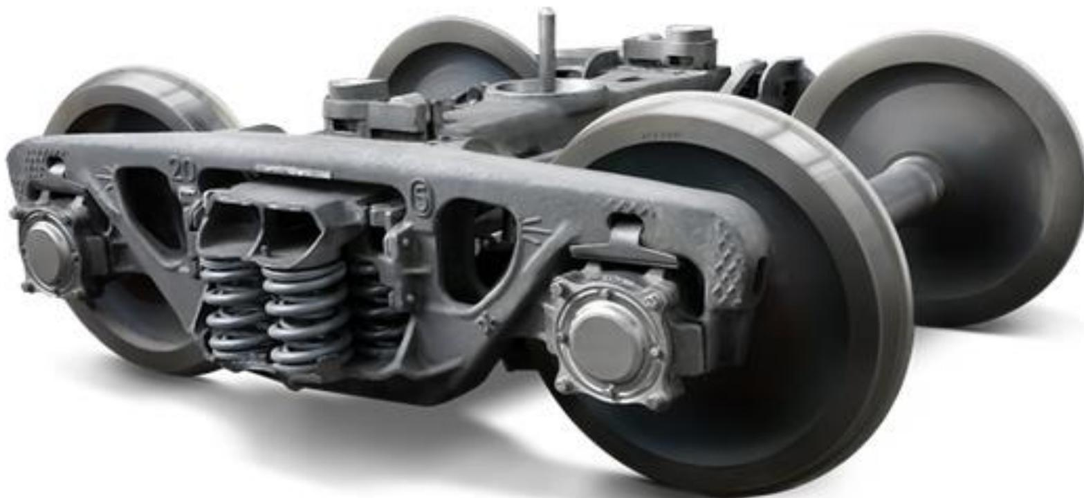
**Ходовые части** необходимы для направления движения по рельсовому пути, восприятия нагрузки от неровности пути и от кузова вагона, плавности хода вагона, равномерного распределения нагрузки на железнодорожные пути (они жестко воздействуют на путь).
