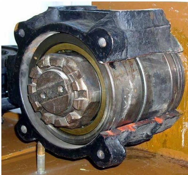
*БУ с роликовыми цилиндрическими подшипниками.*
