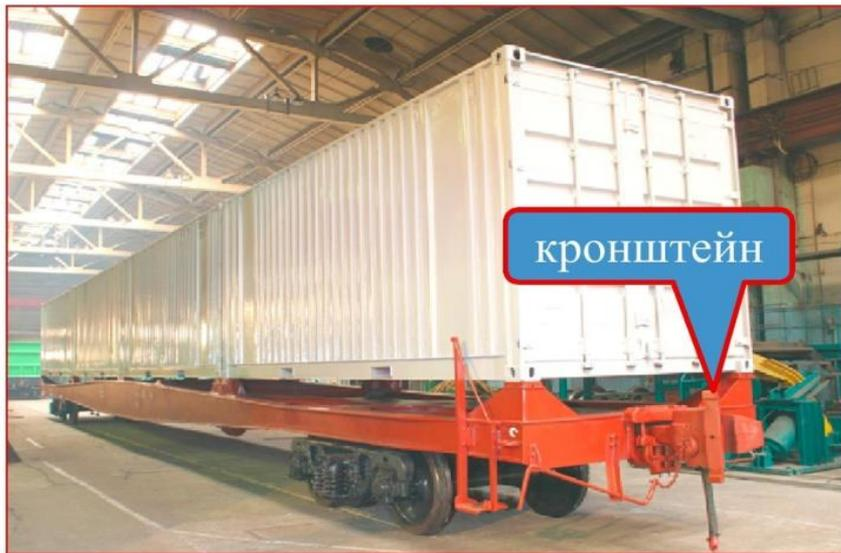
Взаимодействуют друг с другом в процессе работы как нежесткие, однако вертикальные перемещения их относительно друг друга ограничены предохранительными кронштейнами, расположенными на малых зубьях корпуса.
