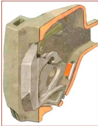
Собачка навешивается на шип замка и обе эти детали вводятся в карман корпуса так, чтобы замок стал на свою опору, а верхнее плечо собачки легло на полочку в корпусе автосцепки. Последнее условие может быть выполнено, если одновременно с введением замка внутрь кармана бородком или другим подобным предметом нажимать на нижнее (фигурное) плечо собачки.
