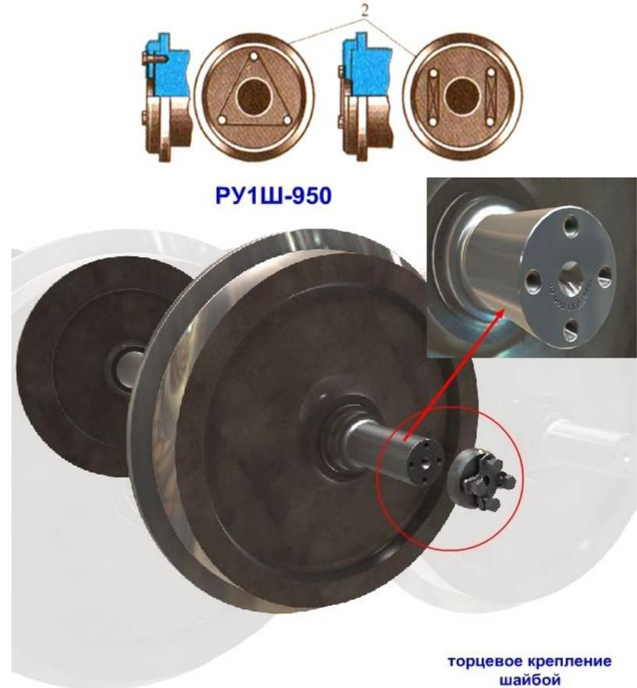
Конструкция торцевого крепления внутренних колец подшипников.
