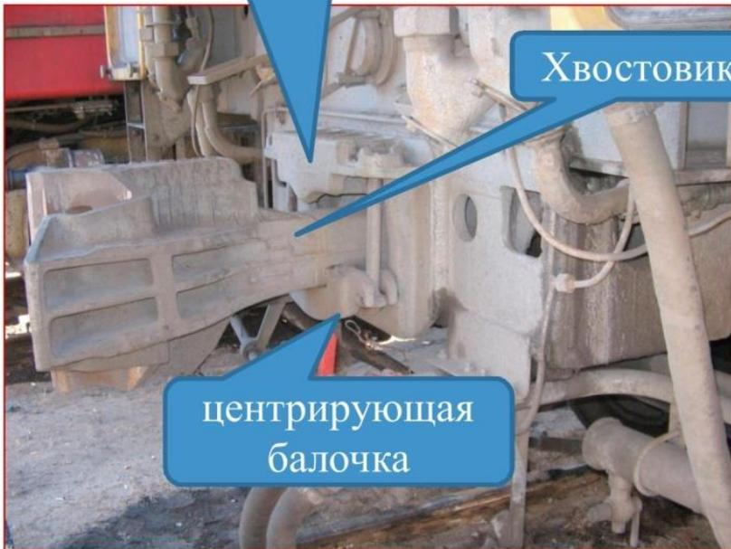
При установке вагонов на кривом участке пути, возникает горизонтальное несовпадение осей сцепных устройств.
