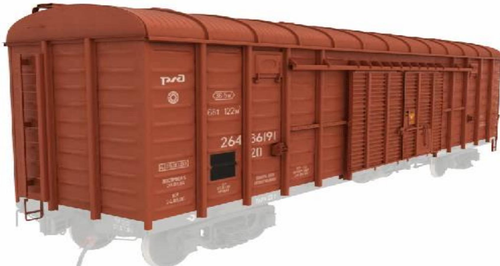
**Кузов** предназначен для перевозки пассажиров или грузов.
