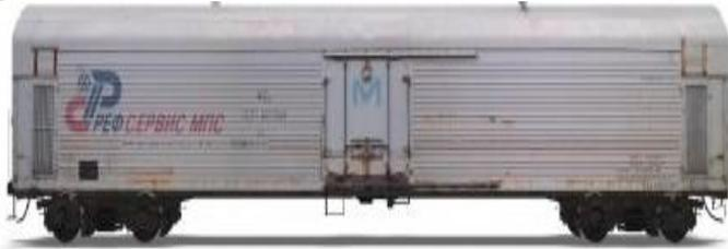
**Изотермические** (4-х осные) – предназначены для перевозки скоропортящихся или боящихся замерзания грузов (мясо, рыба, молоко, минеральная вода, фрукты). Кузова имеют изоляцию и оборудованы системой охлаждения, отопления и вентиляции.
