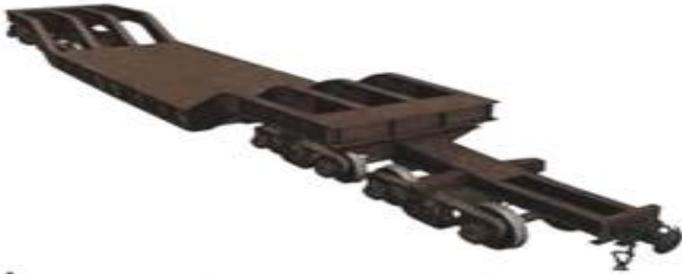
**Транспортеры** (от 6-ти до 40 осей) – предназначены для перевозки крупногабаритных и тяжеловесных грузов, которые по своим размерам или массе не могут быть перевезены в других вагонах (крупные отливки, фермы мостовых кранов, трансформаторы, турбины, генераторы). Средняя часть рамы расположена ниже для удобства погрузки /выгрузки).
