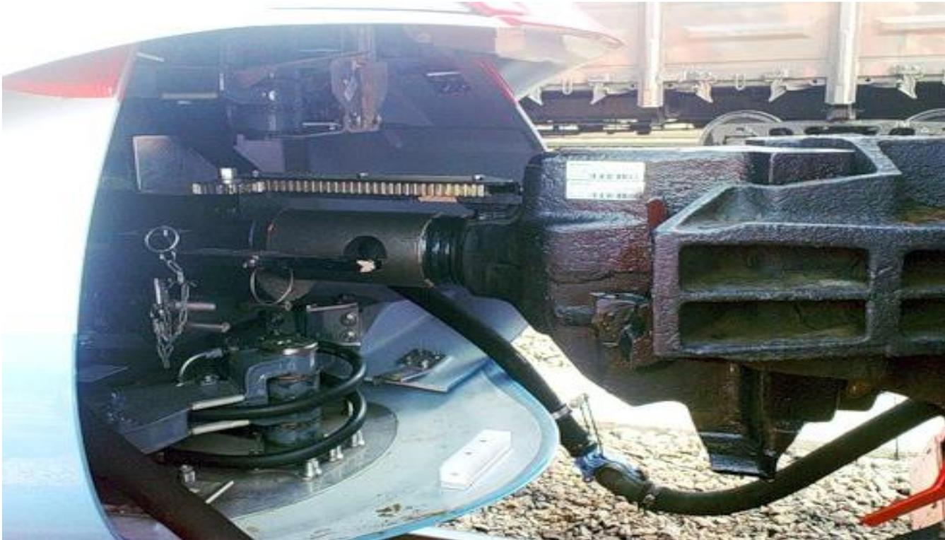
**Ударно-тяговые приборы** предназначены для сцепления вагонов между собой и с локомотивом, удержания их на определённом расстоянии друг от друга, смягчения действия растягивающих и сжимающих усилий, которые возникают в процессе движения. Состоят из автосцепного оборудования и упругих переходных площадок с буферными комплектами.
