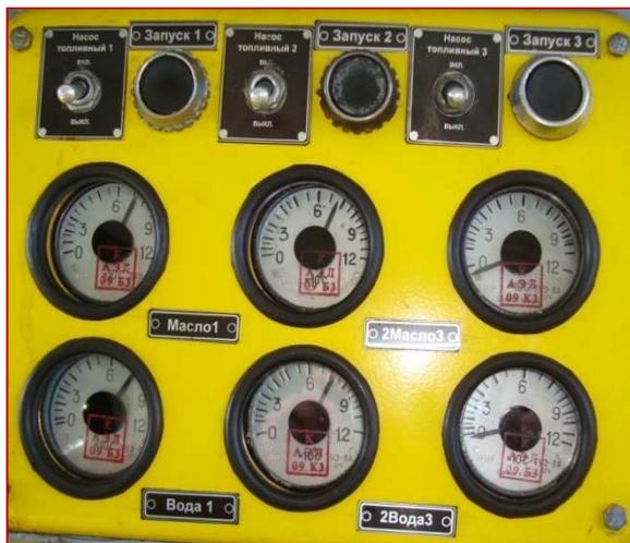
Перед нагрузкой дизеля (перед отправлением поезда) необходимо снова проверить **температуру воды (не ниже 60 °С), масла (не ниже 50 °С) ПУ**, а на первом перегоне или перед отправлением закрыть дренажный вентиль (в зависимости от местных условий), который открыть после остановки дизеля для слива несгоревшего масла из выпускных коллекторов.
