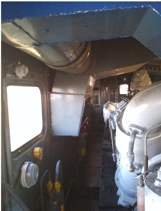
Масляные ванны воздушных фильтров непрерывного действия (ФНД) и маслоплёночных фильтров (МПФ) в летнее время заправляются маслом, применяемым в системе смазки дизеля, в зимнее время – смесью указанного масла и дизельного топлива. Соотношение масла и дизельного топлива для ФНД должно быть 1:1, для МПФ – 1:3.
