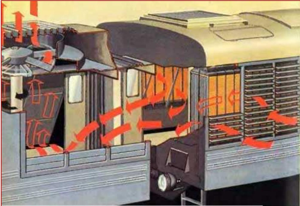
На больной секции разъединить привод вентилятора, полностью открыть боковые и закрыть верхние жалюзи, снять боковые монтажные люки и закрыть нижние люки в шахте.
