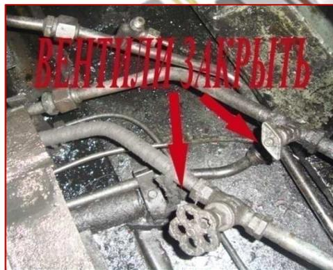
На неисправной секции закрыть сливные топливные краны от топливоподогревателя и заглушить нагнетательную трубку у **ФТО**, чтобы не перекачивалось топливо из одного бака в другой.
