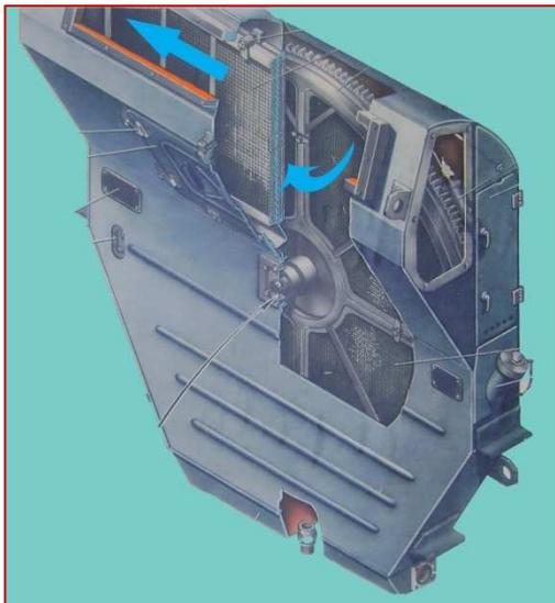
**Уход за воздушными фильтрами и системой охлаждения наддувочного воздуха.**
