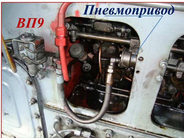
Замедленное перемещение тяг может быть вызвано недостаточным давлением воздуха в системе автоматики (менее  $5 \text{ кг/см}^2$  пропуском воздуха через клапаны электропневматических вентилях и манжеты цилиндров, плохим закреплением воздухоподводящих трубок или заеданием тяг.
