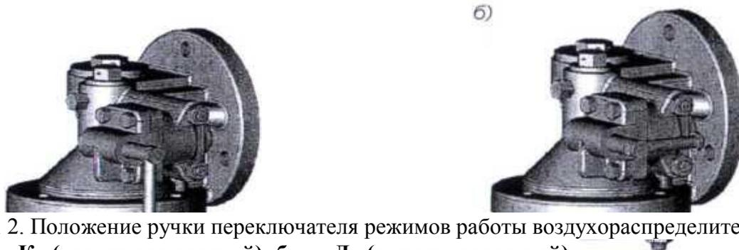
Рис. 2. Положение ручки переключателя режимов работы воздухораспределителя №242-1: а — «К» (короткосоставный); б — «Д» (длинносоставный)
