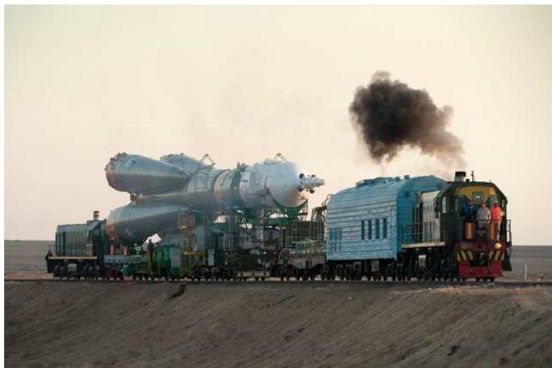
Рис.5 Перевозка негабаритного груза
