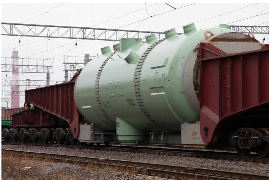
Рис. 2 Сверхнегабаритный груз погруженный на транспортере.
