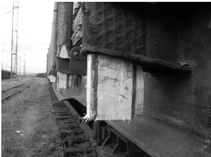
Рис.7 Стойки в стоечных скобах
