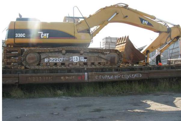
Рис. 1 Размещение негабаритного груза.
