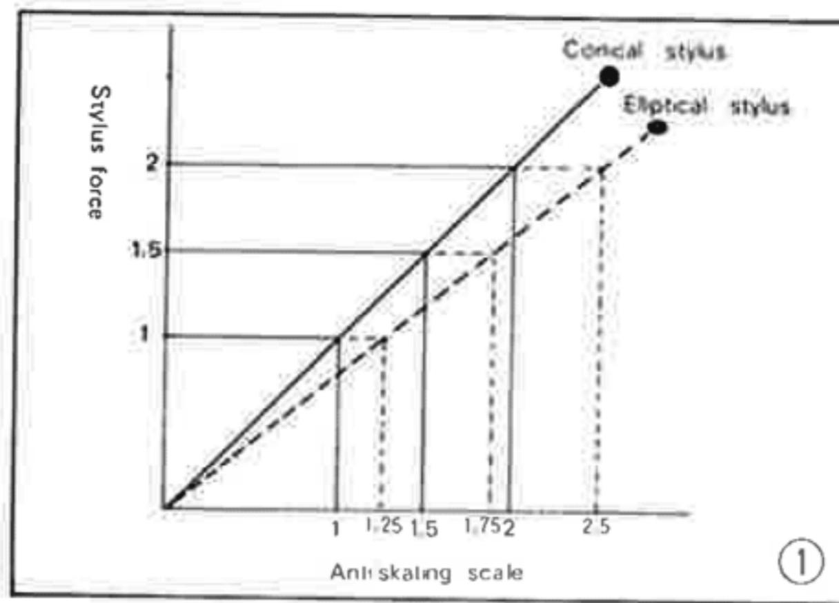
Gibt der Hersteller Ihres Tonabnehmers einen Auflagekraftbereich an, so wählen Sie einen Wert am oberen Ende dieses Bereichs (z.B. maximale Auflagekraft minus 10%). Das fertig montierte MM1 benötigt als optimale Auflagekraft 2,0p. (= 20mN).
