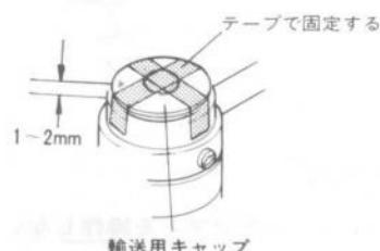
輸送が終わって水平に設置した後も、すぐに輸送用キャップを外さずにオイルが安定するまで1時間以上放置してください。
