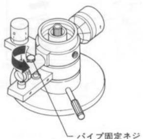
2. アームパイプを止まるまで奥へ差し込み、パイプ固定ネジを矢印の方向へ回して固定する。
