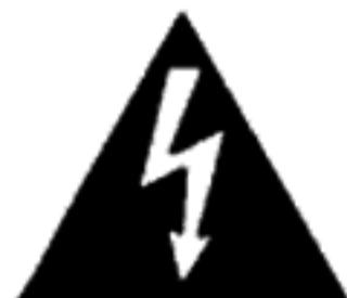
Een bliksempijl in een gelijkzijdige driehoek betekent de aanwezigheid van niet-geïsoleerde "gevaarlijke spanningen" in het inwendige van het apparaat. Deze spanningen kunnen zo groot zijn dat ze het gevaar van een elektrische schok opleveren.
