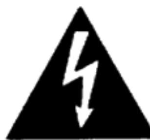
Der in einem gleichseitigen Dreieck abgebildete Blitz mit einem Pfeilspitzen-Symbol weist auf nicht-isolierte "gefährliche Spannung" im Innern des Gerätes hin, die elektrische Schläge verursachen kann.
