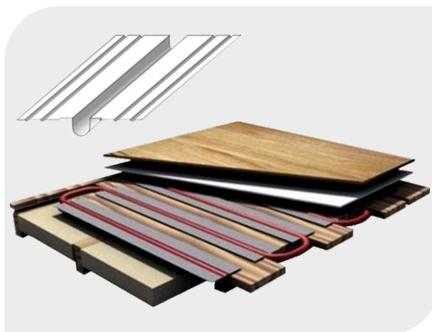
**2 вариант – бруски и теплораспределяющие пластины.**
