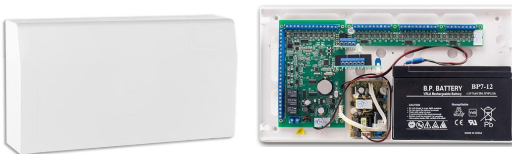
Рис. 1. Системный блок (вид снаружи и внутри)
