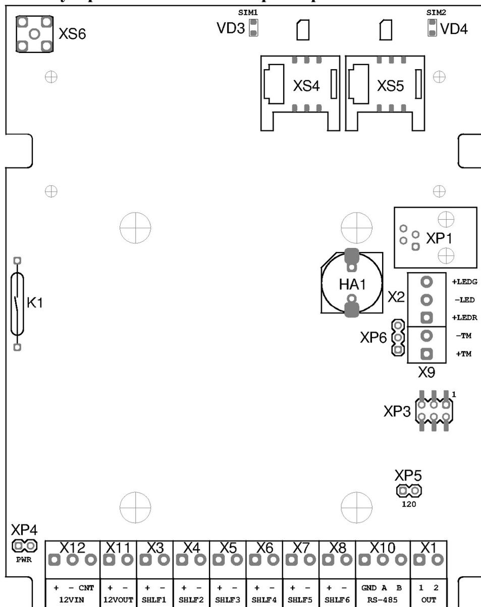
Рис.9 Внешний вид платы контроллера. Клавиатура и ЖКИ условно не показаны.
