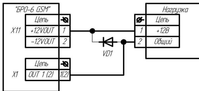
Рис.7 Подключение выходов при использовании источника питания, питающего блок (Напряжение на нагрузке 10,0...14В, максимальный ток потребления 500мА. Диод VD1 нужен, если нагрузкой является катушка реле. Допустимое обратное напряжение диода должно быть не менее 20В)
