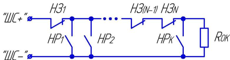
Рис.2 Схема подключения охранных датчиков (HЗ – нормально замкнутый контакт охранного датчика; НР – нормально разомкнутый контакт охранного датчика; Rок – оконечный резистор номиналом 4,7 кОм ±5%. Максимальное допустимое сопротивление проводов шлейфа в данной схеме – 470 Ом; минимальное допустимое сопротивление утечки между проводами шлейфа – 18 кОм; максимальный допустимый ток утечки – 0,6 мА).
