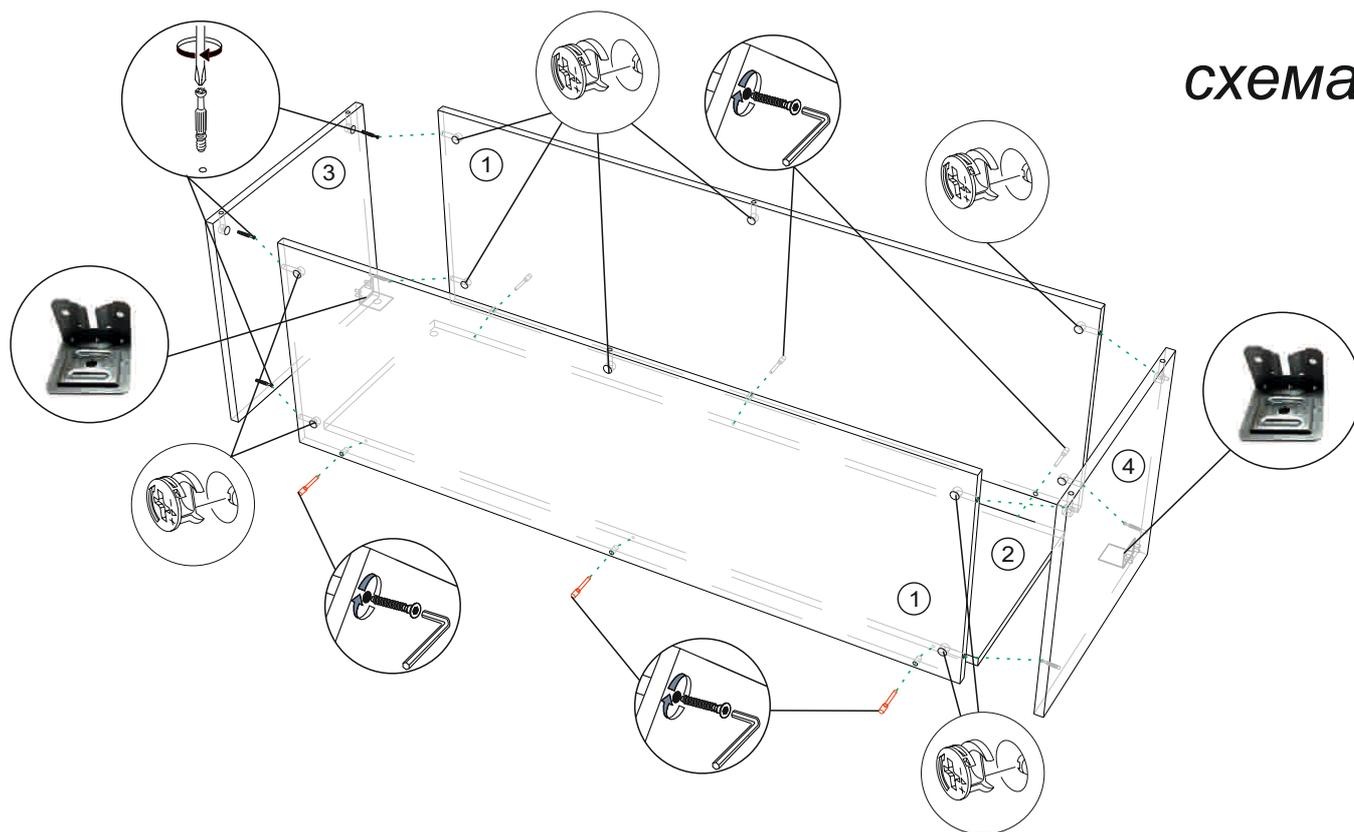
3. К собранной конструкции закрепите планки №5 с помощью эксцентриковых стяжек как показано на схеме 2.
