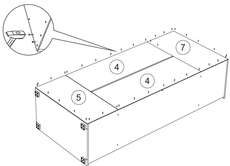
**5. Закрепите карниз на верхнюю крышку с использованием шурупов 4x25 и пластиковых шайб**
