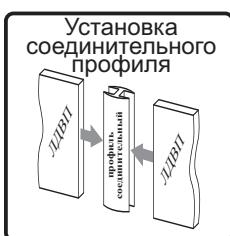
4. Для закрепления задних стенок положите изделие горизонтально, лицевой стороной вниз. Далее следует выровнять диагональ при помощи рулетки, после чего закрепить панели №4, №5, №7 гвоздями, предварительно соединив панели 4 профилем.
