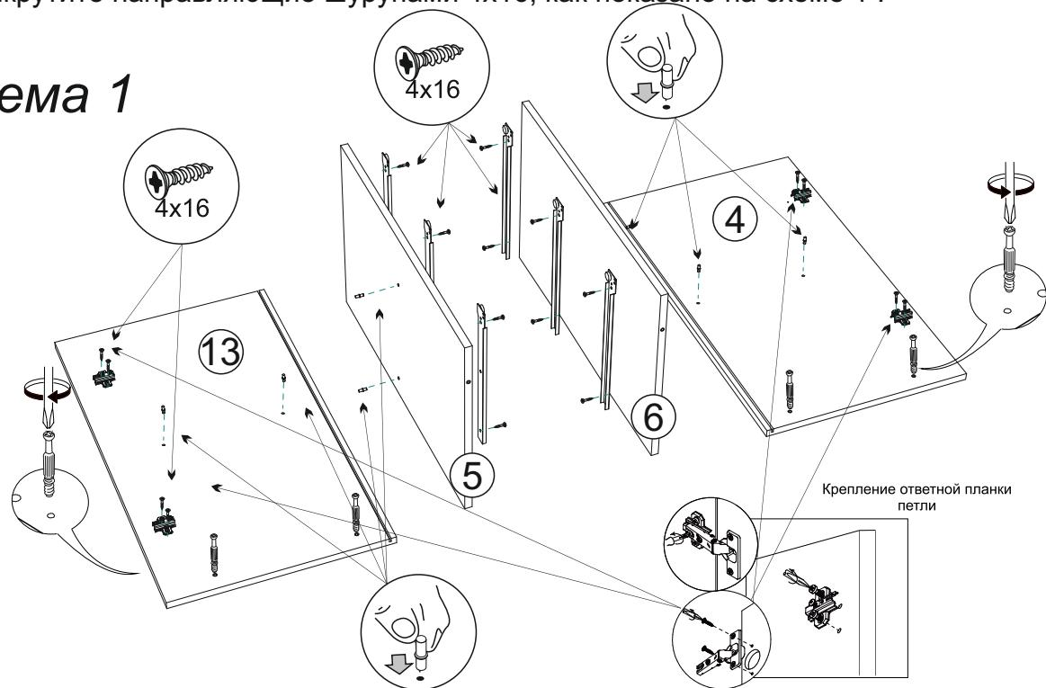
2. Соберите каркас Тумбы ТВ. Для этого соедините боковины №13,4 и перегородки №5,6 с вязкой №2 при помощи эксцентриковых стяжек и евровинтов. Закрепите опоры к вязке №2. Вставьте задние стенки (ЛДВП) №11 в пазы на боковинах и в паз вязки №2 соединив между собой бруском соединительным №1. Затем присоедините крышку №14 при помощи эксцентриковых стяжек как показано на схеме 2. Переверните Тумбу ТВ лицевой стороной вниз и проверив диагональ Тумбы ТВ, зафиксируйте ЛДВП уголками Rv8 и гвоздями.
