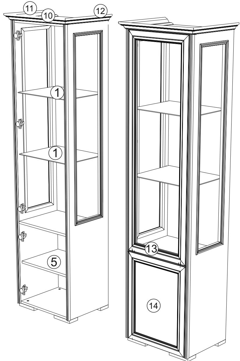
4. Установите шкаф на место. Вставьте стеклополки №1 в стеклодержатели и зафиксируйте. Установите полку №5 как показано на схеме 3.
