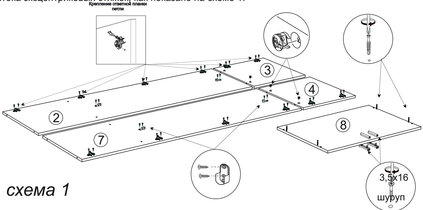
3. Соберите каркас шкафа. Для этого соедините боковины №2 и №7 евровинтами с вязкой №6 и крышками №5 и №8 а боковины №3 и №4 с крышкой №5, затем присоедините боковины №3 и №4 к крышке №8 при помощи эксцентриковых стяжек, прикрутите опоры шурупами 4x25, как показано на схеме 2.
