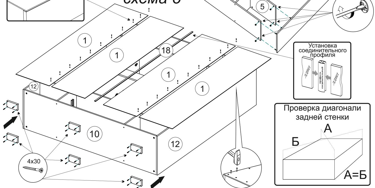
7. Соберите ящики. Для этого сначала евровинтами скрепите детали 4 и 8, затем вставьте в пазы дно ящика ЛДВП 2, после этого евровинтами закрепите деталь 7. Шурупами 4x30 закрепите фасад ящика 26 к детали 7, затем закрепите ручки винтами M4x45, предварительно обрезав их до нужной длины. Шурупами 4x16 закрепите ответные части направляющих на боковины ящика 4 (схема 6).
