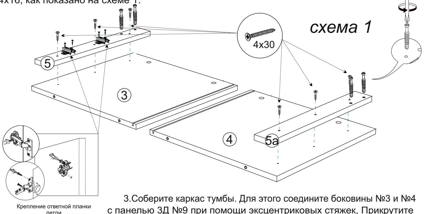
3. Соберите каркас тумбы. Для этого соедините боковины №3 и №4 с панелью ЗД №9 при помощи эксцентриковых стяжек. Прикрутите евровинтами крышку №2 к боковинам №3 и №4, планку №6 присоедините шурупами 4x30. Вставьте заднюю стенку (ЛДВП) №7 в пазы на боковинах №3 и №4 и крышке №2. Оденьте крышку №1 и затяните эксцентриковые стяжки, прикрутите шурупами 4x25 опоры, как показано на схеме 2.
