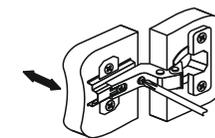
Регулировка створки по глубине
