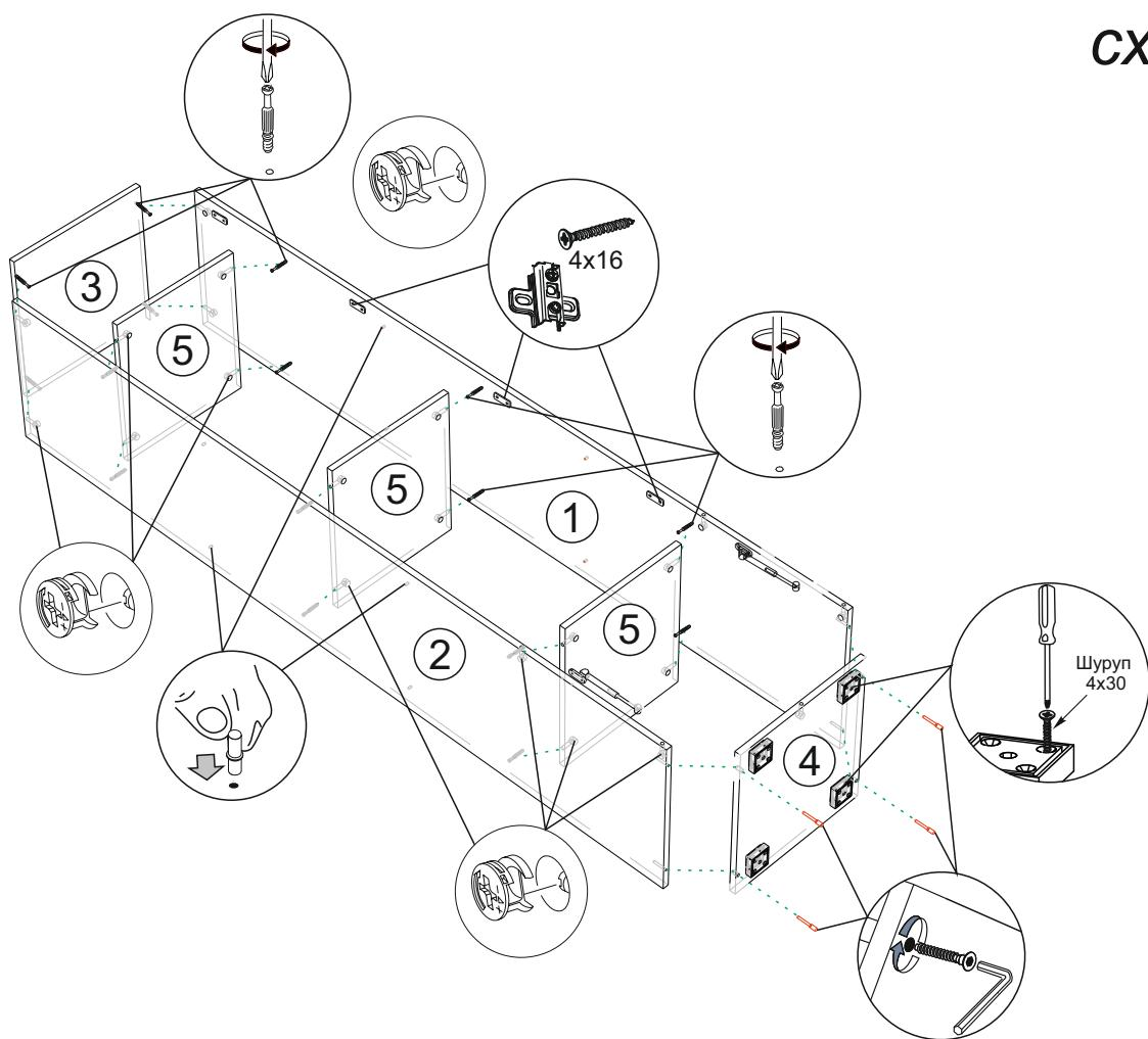
3. Чтобы установить заднюю стенку №10, необходимо собранную конструкцию перевернуть лицевой стороной вниз. Замерить, с помощью рулетки, и уравнять диагонали ( $a=b$ ). Наложите заднюю стенку и аккуратно, не нарушая диагоналей, прибейте ЛДВП гвоздями с шагом 130-150мм как показано на схеме 2.
