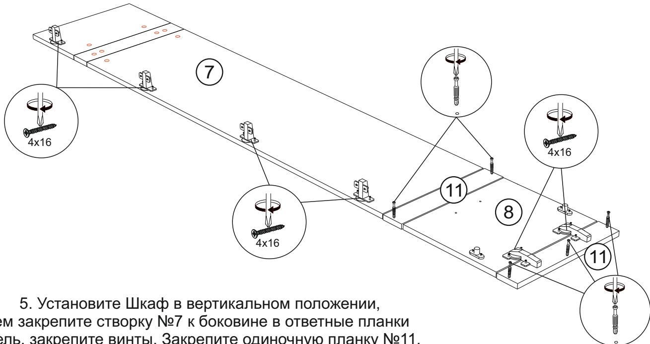
5. Установите Шкаф в вертикальном положении, затем закрепите створку №7 к боковине в ответные планки петель, закрепите винты. Закрепите одиночную планку №11, затем собранную створку №8 с планкой №11 закрепите к нижней крышке. Закрепите ручки с помощью шурупов 3.5x30. Установите полки №6 как показано на схеме 4.
