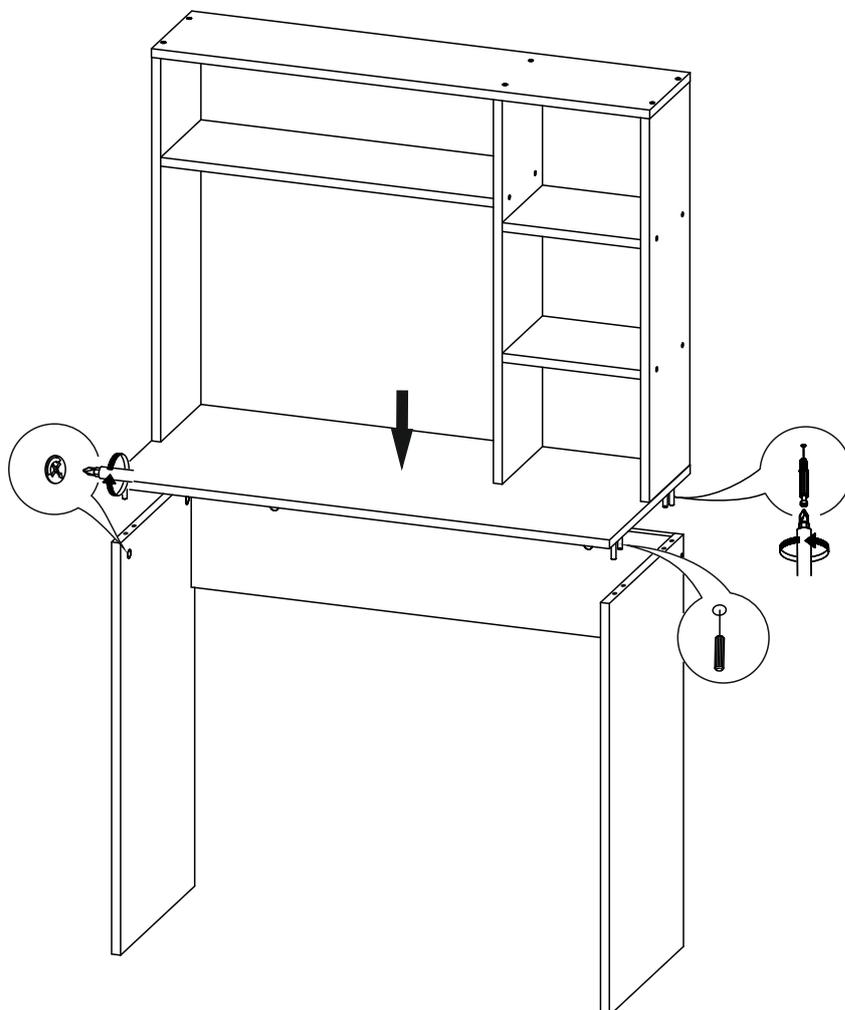
6. В соответствующие отверстия на крышке вернуть штоки эксцентриков односторонние и вставить шканты 8x30
