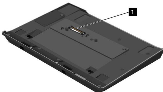
**1 Разъем док-станции:** место подключения компьютера ThinkPad к аккумулятору ThinkPad Battery 19+.
