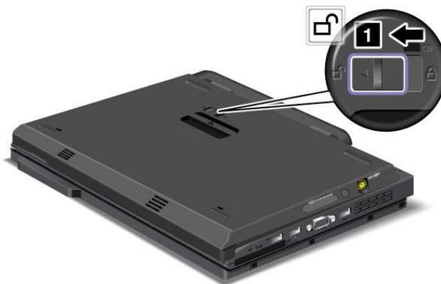
2. Нажмите на рычаг извлечения **2** и отсоедините аккумулятор ThinkPad Battery 19+.
