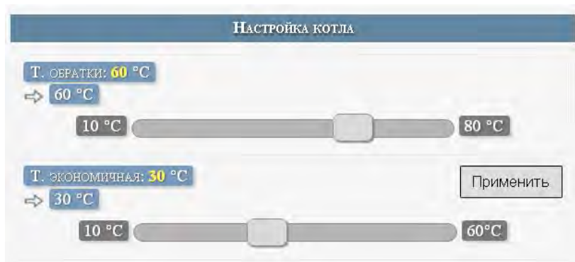
Рис.8.5. Вкладка настройки котла.
