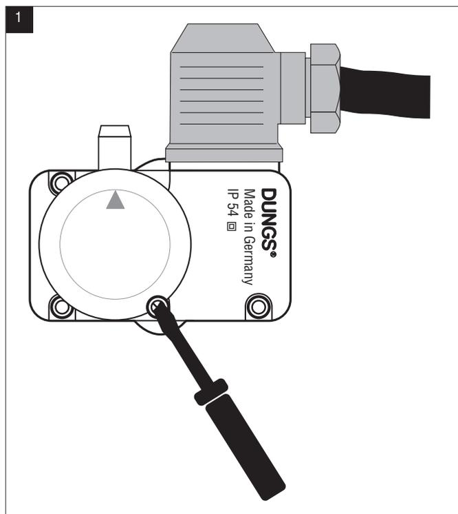
Реле давления установите с помощью регулировочного колесика со шкалой на заданное значение давления, рис. 2.
