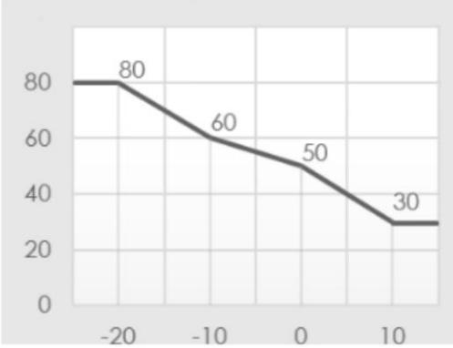
По этому графику при  $-15^\circ$  на улице,  $T$  теплоносителя будет равна  $70^\circ$ .
