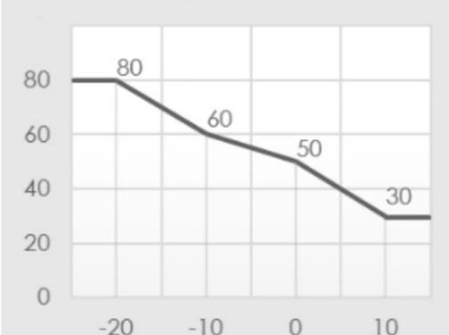
По этому графику при  $-15^{\circ}$  на улице,  $T$  теплоносителя будет равна  $70^{\circ}$ .
