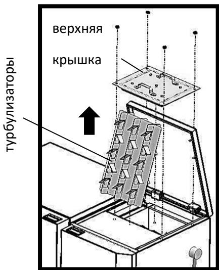
Регулярно следует проводить очистку турбулизаторов (рис. 49). Для этого, следует открыть правую крышку корпуса котла. Снять верхнюю крышку, открутив гайки (4 шт), и достать турбулизаторы.
