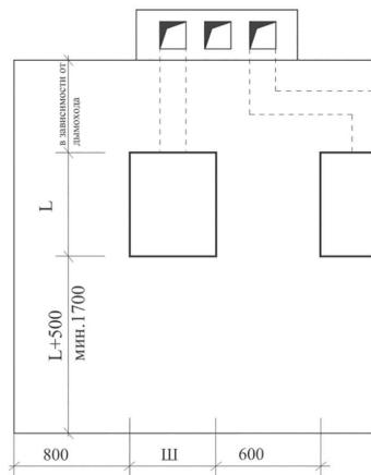
*Рис. 9. Планировка котельной*
