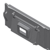
Рис. 3. Регулировочная дверца подачи первичного воздуха
