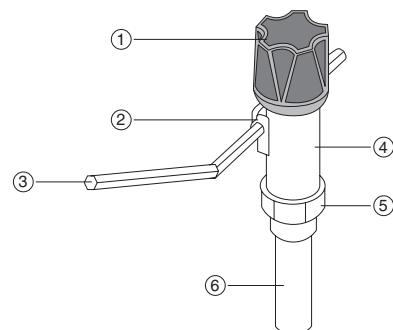
Рис. 2. Термомеханический регулятор мощности (TPM):
