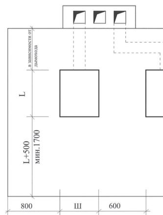
Рис. 9. Планировка котельной
