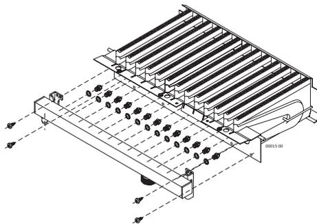
**(i)** \* Установите форсунки поставляемые в наборе вместе с шайбами, даже если у форсунок стандартного оснащения котла изначально шайб нет.
