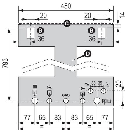
ния непосредственно в момент навески. Если не используется металлический шаблон многоразового использования и / или оригинальный Комплект подсоединения, о позиции гидравлических подключений котла можно прочитать в параграфе «Габаритные и присоединительные размеры» на стр. 18.
