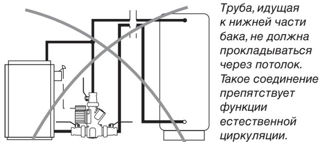
*Внимание! При таком подсоединении радиаторов имеется большая опасность оставления тепла в котле и/или снижении подачи тепла в контур радиаторов.*
