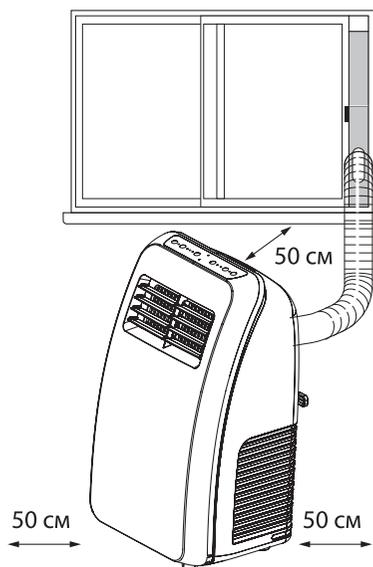
1. Выберите подходящее место для установки кондиционера с удобным доступом к электрической розетке.
