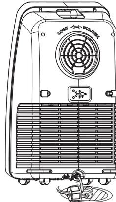
2. Сначала отключите прибор от электропитания, снимите заглушку с дренажного отверстия и подсоедините дренажный шланг, обеспечив специальную емкость для сбора конденсата либо дренажное отверстие.
