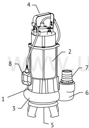
Насос представляет собой моноблочный агрегат, корпус которого разделен на гидравлическую часть (1) и электродвигателя (2). Однофазный асинхронный электродвигатель с пусковым конденсатором размещен в закрытом от попадания жидкости кожухе из нержавеющей стали.
