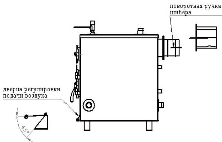
Рисунок 7 - Положение шибер и дверки регулировки подачи воздуха при растопке
