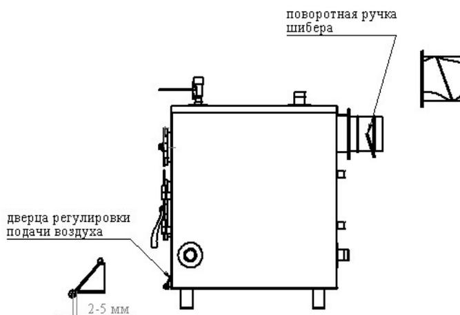
Рисунок 9 – Положение шибера и дверки регулировки подачи воздуха в экономном режиме
