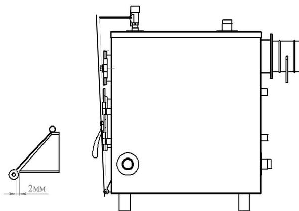
Рисунок 10 - Настройка цепи регулятора
