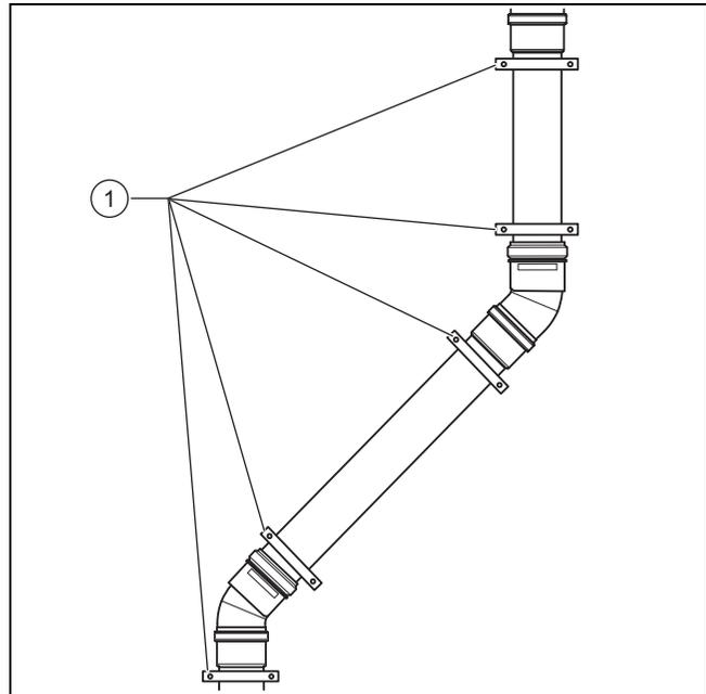
5. Смонтируйте на удлинителе после каждого отвода 45° дополнительный хомут (1).
