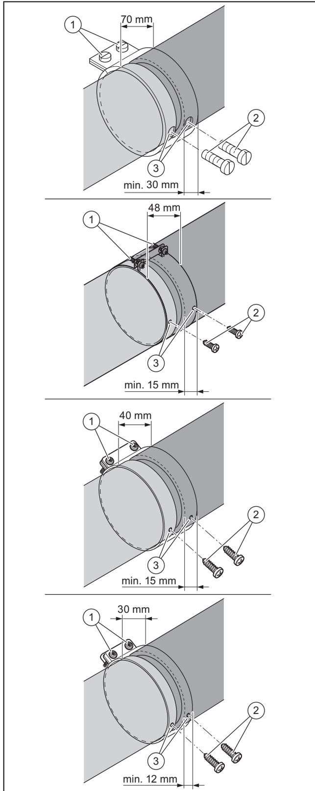
2. Надвиньте трубный хомут воздуховода на стык труб воздуховода и затяните винты (1).
