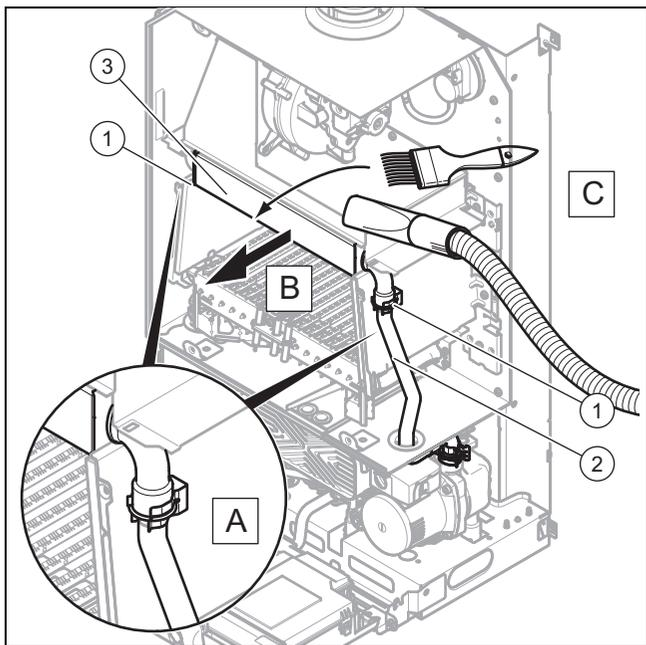
2. Снимите скобы на трубе подающей и обратной линии (1).
