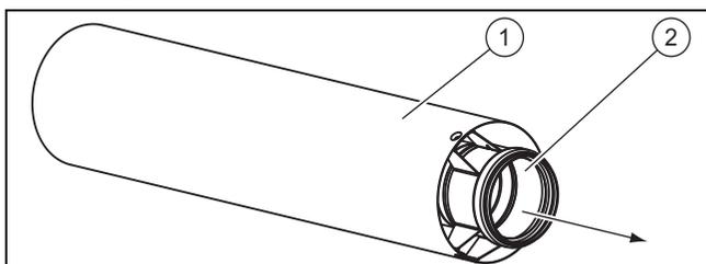
1. Вытяните трубу отходящих газов (2) из трубы воздуховода (1).
