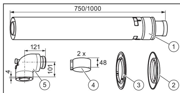
1 Горизонтальный проход через стену/крышу (телескопический 0,45 – 0,65 м)
