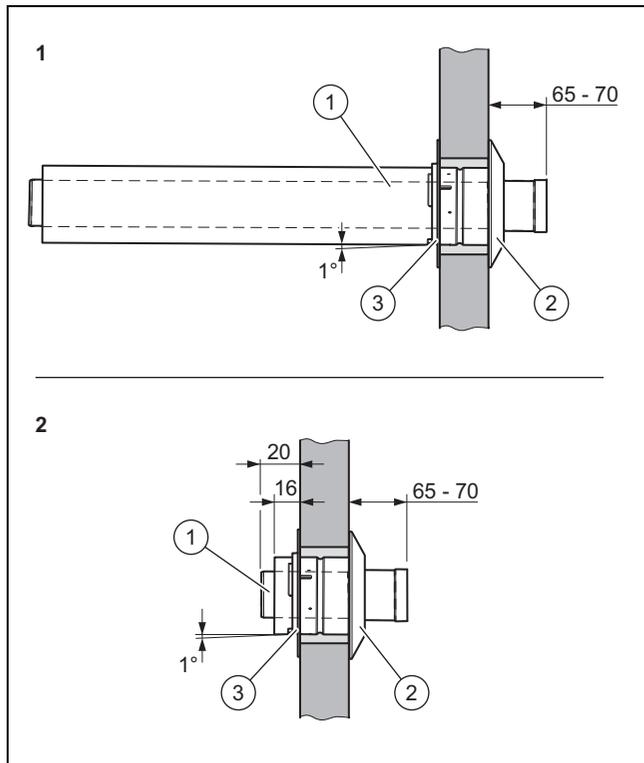
1. Как при прямой, так и при непрямой установке (А) необходимо учитывать габариты (В) теплогенератора.
