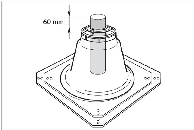
8. Проверьте, чтобы над основанием оголовка шахты выступало 60 мм.
