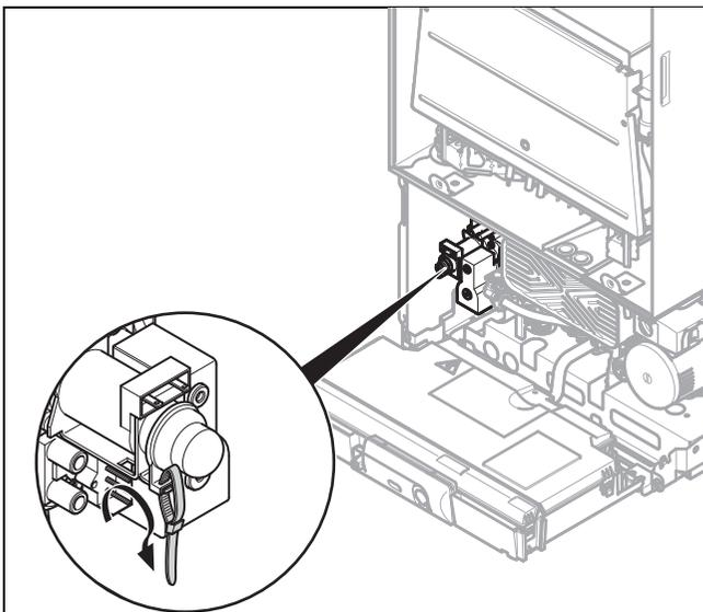
14. Зафиксируйте крышку вентиля кабельной стяжкой или лаком.
