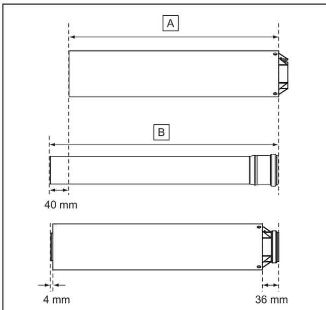
2. Сначала отмерьте необходимый кусок воздуховода\* (A), и затем рассчитайте длину соответствующего дымохода (B):
