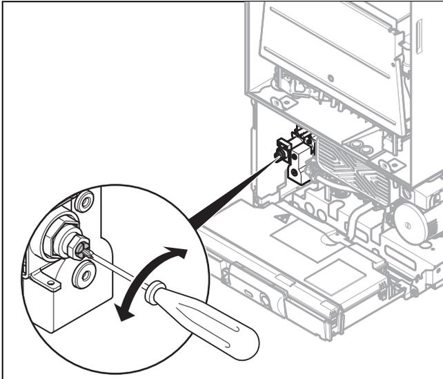
10. Настройте минимальную тепловую нагрузку с помощью отвертки.
