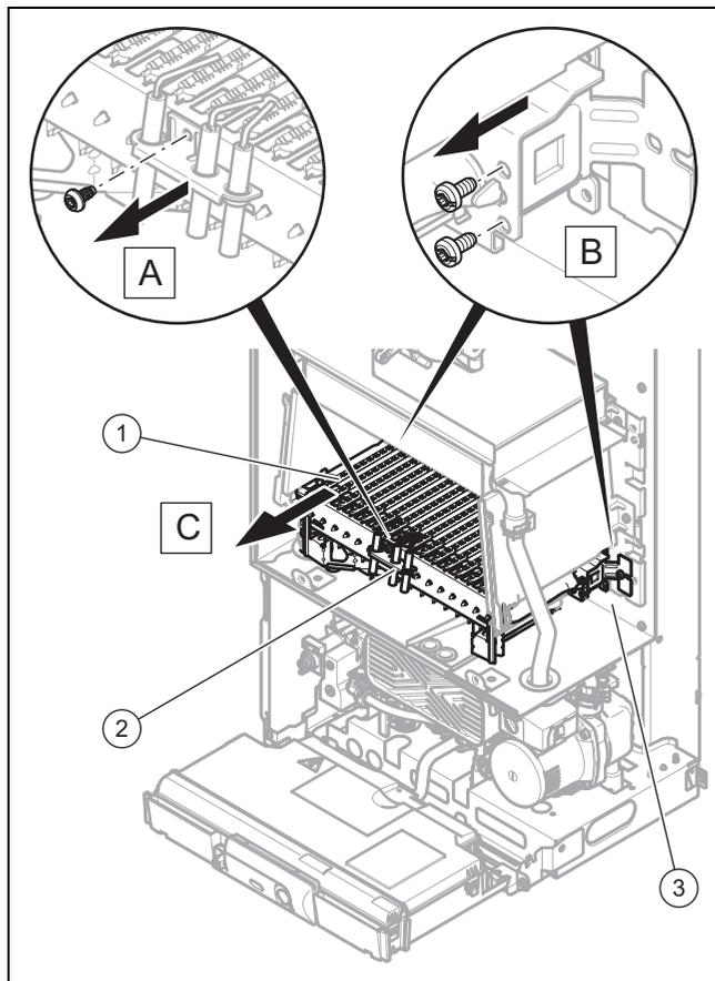
2. Открутите винт электрода контроля пламени и розжига(2) на горелке.
