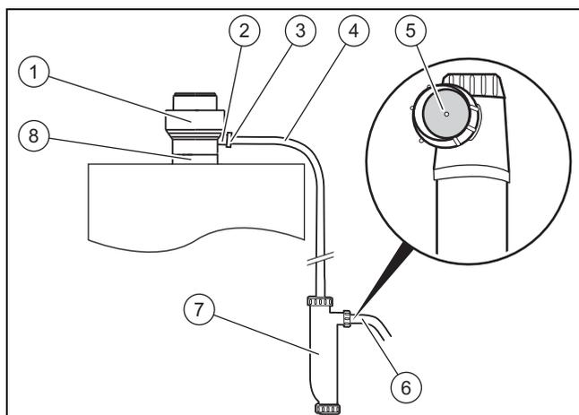
1. Вставьте соединительный элемент (1) в соединительный патрубок отходящих газов изделия.
