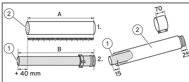
7. Сначала отмерьте необходимый кусок воздуховода\* (A), и затем рассчитайте длину соответствующего дымохода (B):
