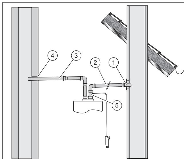
1. Вставьте в шахту трубу отвода отработавших газов (1).
