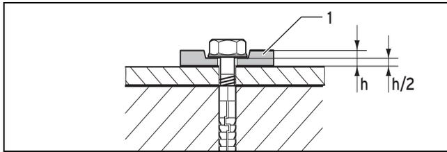
4. Закрепите основание оголовка шахты четырьмя винтами на краю устья.
