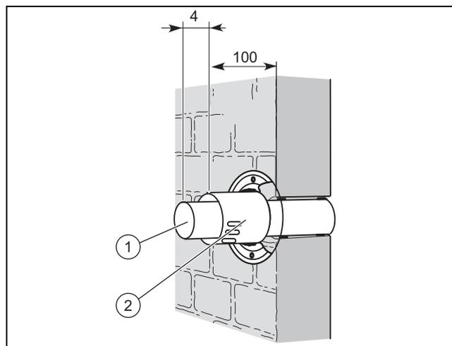
1. Просверлите отверстие для дымохода 60 мм в вертикальной части дымохода.
