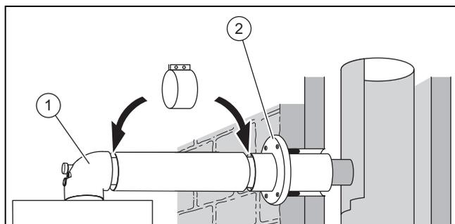
1. Надвиньте стеновую накладку (2) на трубу воздуховода.
