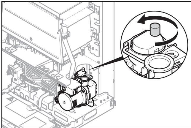
4. Снимите колпачок быстродействующего воздухоотводчика.
