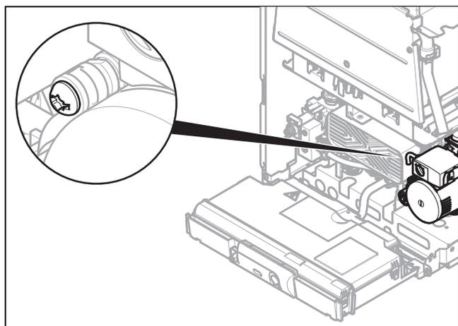
3. Отрегулируйте давление регулировочным винтом (1).
