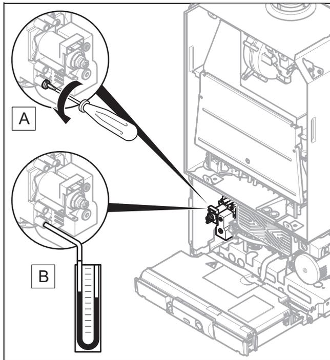
3. С помощью отвертки выкрутите уплотнительный винт из отверстия для измерительного прибора газовой арматуры.
