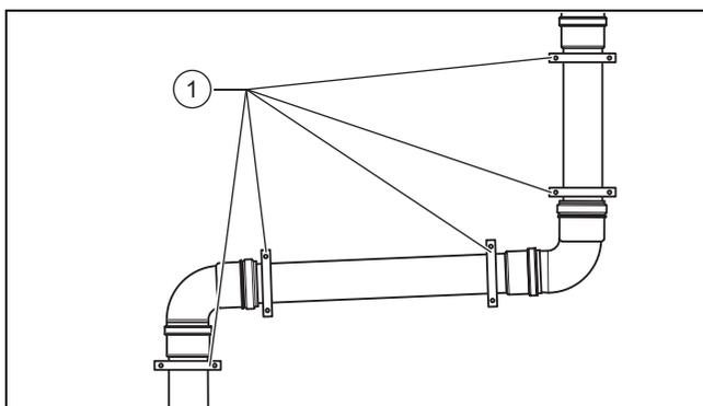
4. Смонтируйте на удлинителе после каждого отвода 87° дополнительный хомут (1).
