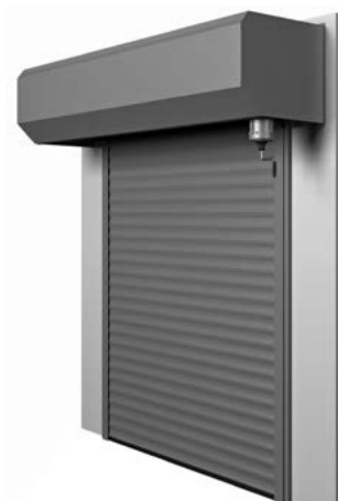
Рис. 15. Наружная коробка для ворот с приводами SI 55, 75. Аварийное открытие рукояткой или цепной передачей.
