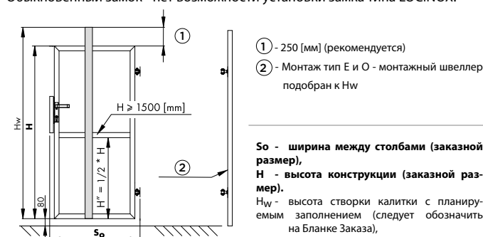
Рис. 8. Схема конструкции калитки для индивидуального заполнения - вид со стороны улицы.
