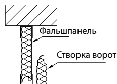
Рис. 10. Фальшпанель выполнена из стальной панели, заполненной пенкой.
