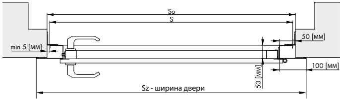
Рис. 20. Монтаж в проёме - вертикальный разрез.
