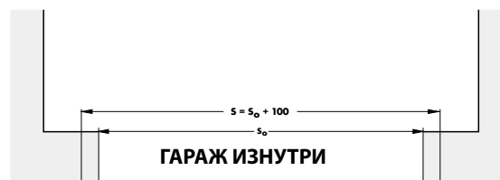
Рис. 31. Монтаж двухстворчатых ворот перед проёмом - поперечный разрез.
