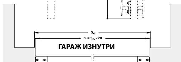
Рис. 29. Монтаж одностворчатых ворот в проёме - поперечный разрез.
