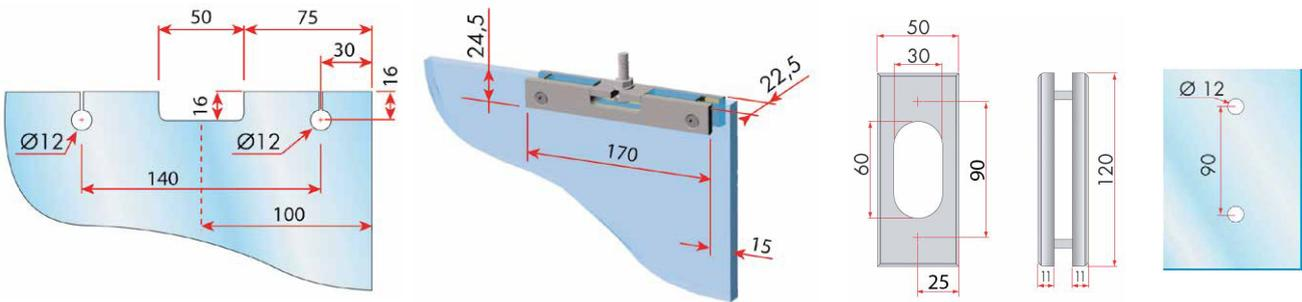
**58.7007.12** Держатель без декоративной крышки для стеклянного полотна с вырезом. Максимальный вес полотна до 80кг
