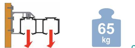
Вес каждого полотна не более 65кг
