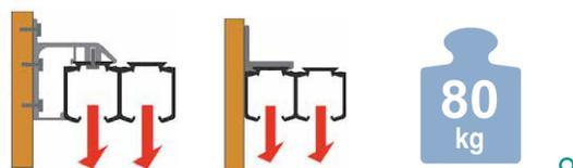
Вес каждого полотна не более 80кг
