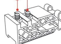
Фиксация осуществляется винтом №1. Жесткость захвата каретки регулируется винтом №2
