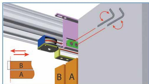
Окончательная «тонкая» регулировка
