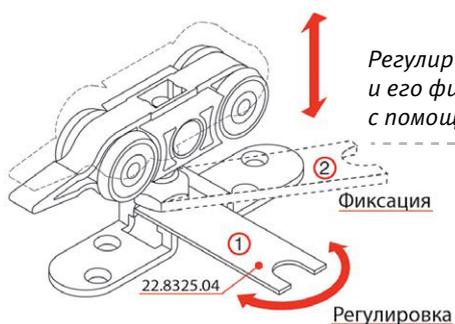
Регулировка полотна по высоте и его фиксация осуществляется с помощью ключа 22.8325.04
