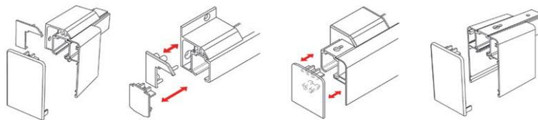
**ИСПОЛЬЗОВАНИЕ СКРЫТЫХ ДЕРЖАТЕЛЕЙ** дает возможность обойтись без декоративных накладок за счет уменьшения зазора между полотном и треком до 4мм. При этом, остаётся возможность регулировки полотна по высоте.
