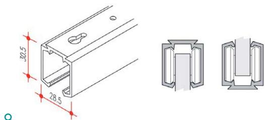
**НЕСУЩАЯ НАГРУЗКА ДО 160 КГ** при возможности использования его как в подвесном, так и в опорном вариантах обеспечивается за счет особой конструкции трека.
