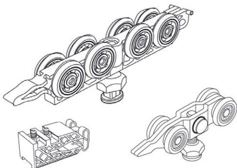
**ОТСУТСТВИЕ ПЕРЕКОСОВ И СКАЧКОВ** при ударе о стопор достигается за счет использования безлюфтовой 8-колесной каретки. Мягкий, плавный и бесшумный ход даже при нагрузке 160кг обеспечивают нейлоновые ролики со встроенными подшипниками. Конструкция регулируемого стопора такова, что он не только ограничивает ход ролика и смягчает удар, но и фиксирует его от подпрыгивания в конечной точке.
