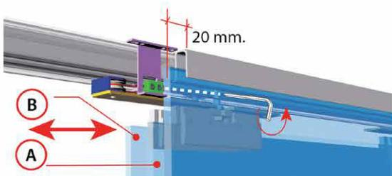
Окончательная «тонкая» регулировка положения полотен
