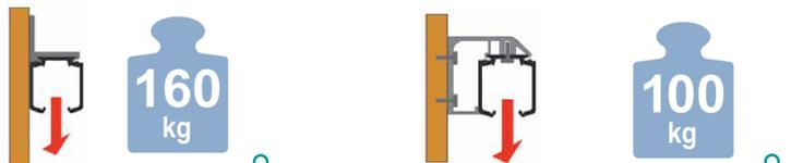
Вес каждого полотна не более 100кг
