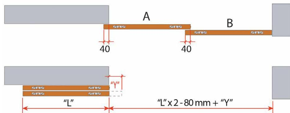
Размер зависит от толщины полотна
