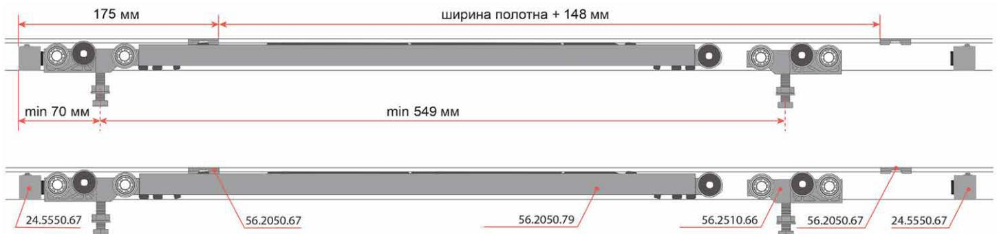
Снятие (установка) доводчика без демонтажа трека
