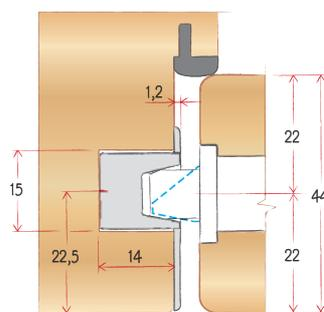
Esempio di applicazione a battente con Mediana Evolution, Polaris XT, Revolution XT
