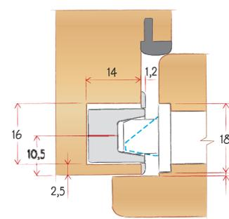
Esempio di applicazione a filo con Polaris XT e Revolution XT
