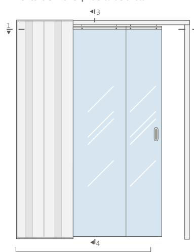
Viga em madeira para reduzir vibrações no teto falso (não fornecido)
