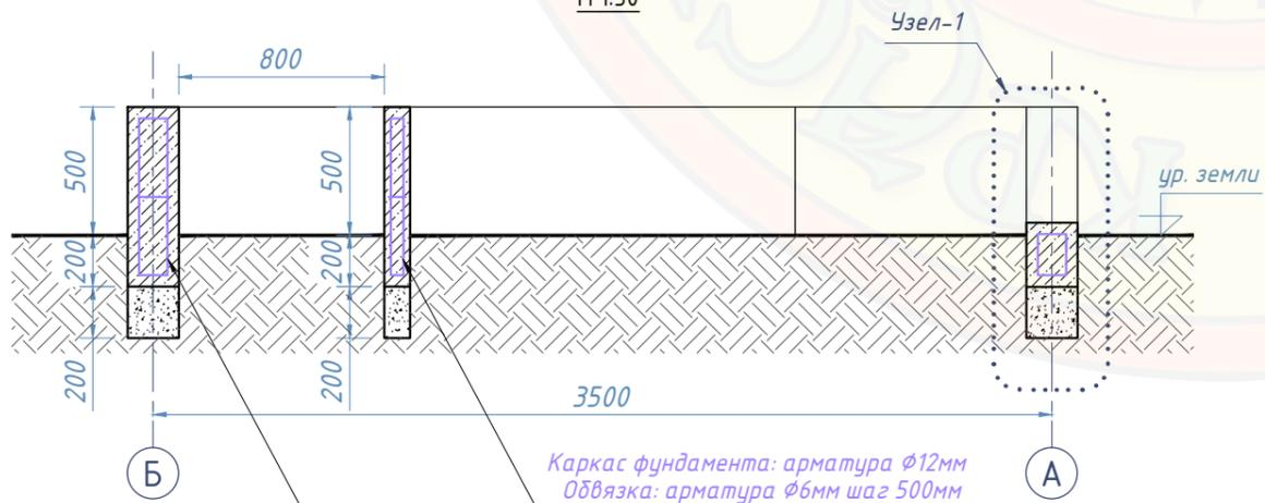
Каркас фундамента: арматура  $\Phi 12\text{мм}$
