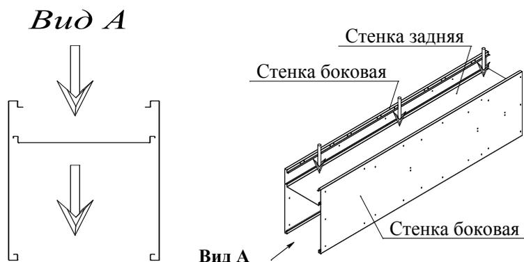
6.2.2. Установить перекрытия. Если вы приобрели шкаф односекционный, приклепать перекрытия нужно к двум боковым стенкам. Если у вас шкаф состоит из двух и более секций нужно приклепать перекрытия только к одной из боковин (на рис. ба-окрашена) и задней стенке.
