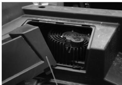
Панель доступа к масляному резервуару
