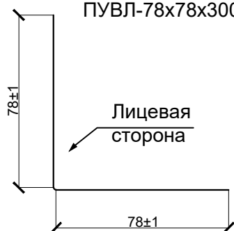
Планка угла внутреннего линейного ПУВЛ-78x78x3000
