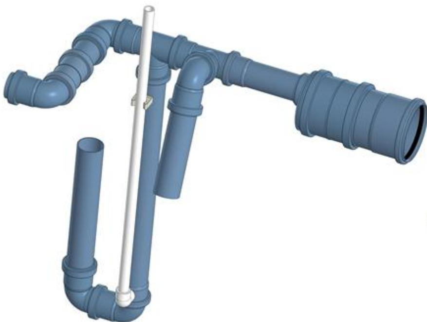
Рисунок 4 - Аэрлифт очищенной воды при принудительном отведении
