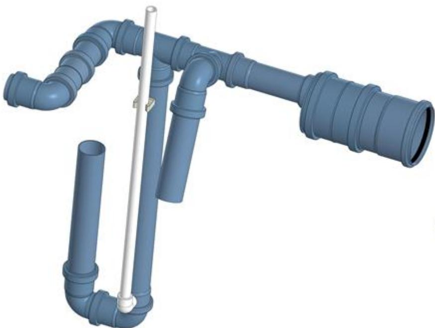
Рисунок 4 - Аэрифт очищенной воды при принудительном отведении
