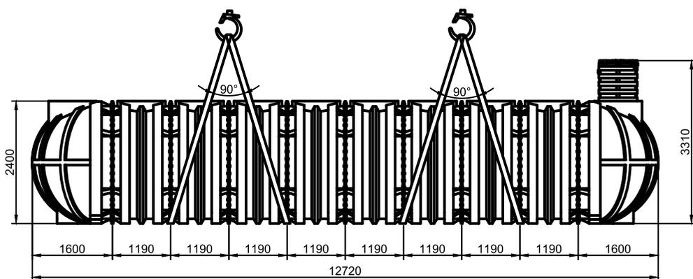
*Схема допустимого способа строповки изделия на 50 000 литров. В случае уменьшения длины емкости, пропорционально уменьшают хват строп.*
