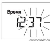
RC150 теперь установлен как регулятор, и на дисплее появляется стандартная индикация. Системы отопления и приготовления горячей воды работают (ГВС постоянно, отопление по программе).
